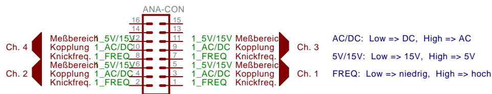
Abbildung 5.9: Schnittstellenspezifikation µC <-> Analog-Board
