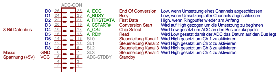
Abbildung 5.7: Schnittstellenspezifikation \mu\text{C} \leftrightarrow \text{ADC}
