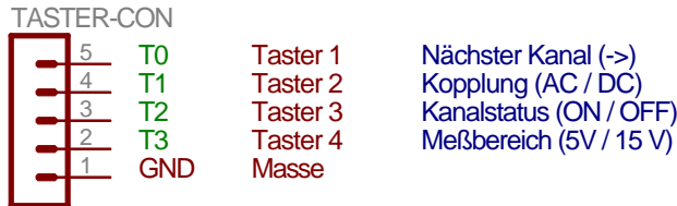
Abbildung 5.11: Schnittstellenspezifikation \mu C < -> Taster
